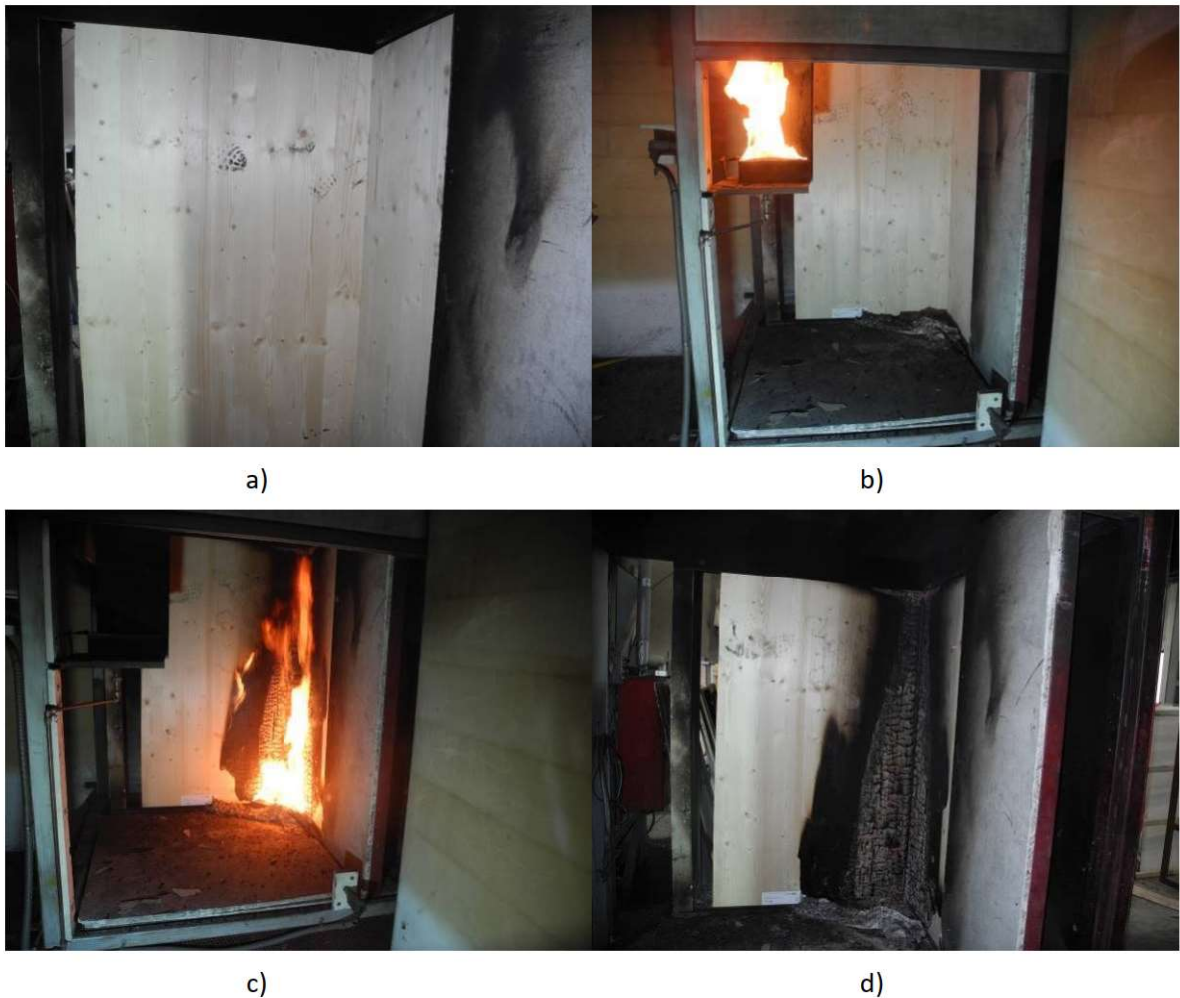
Fot. 6.5. Fazy badania drewna na klasę od B do D według SBI [N17]: a) element z drewna klejonego CLT przed badaniem; b) – elementy w początkowej fazie badania; c) element w końcowej fazie badania; d) element po badaniu. (fot. P. Sulik)
