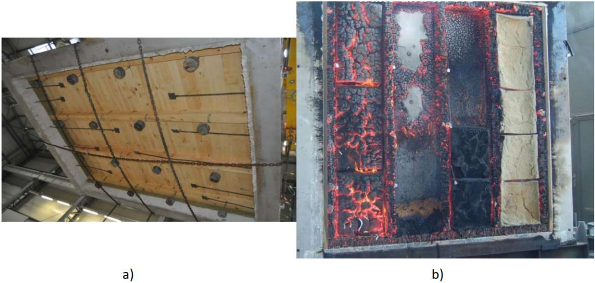
Fot. 6.12. Widok elementów o konstrukcji drewnianej od strony nagrzewanej: a) strop przed badaniem, b) ściana po badaniu (fot. Z archiwum ITB)
