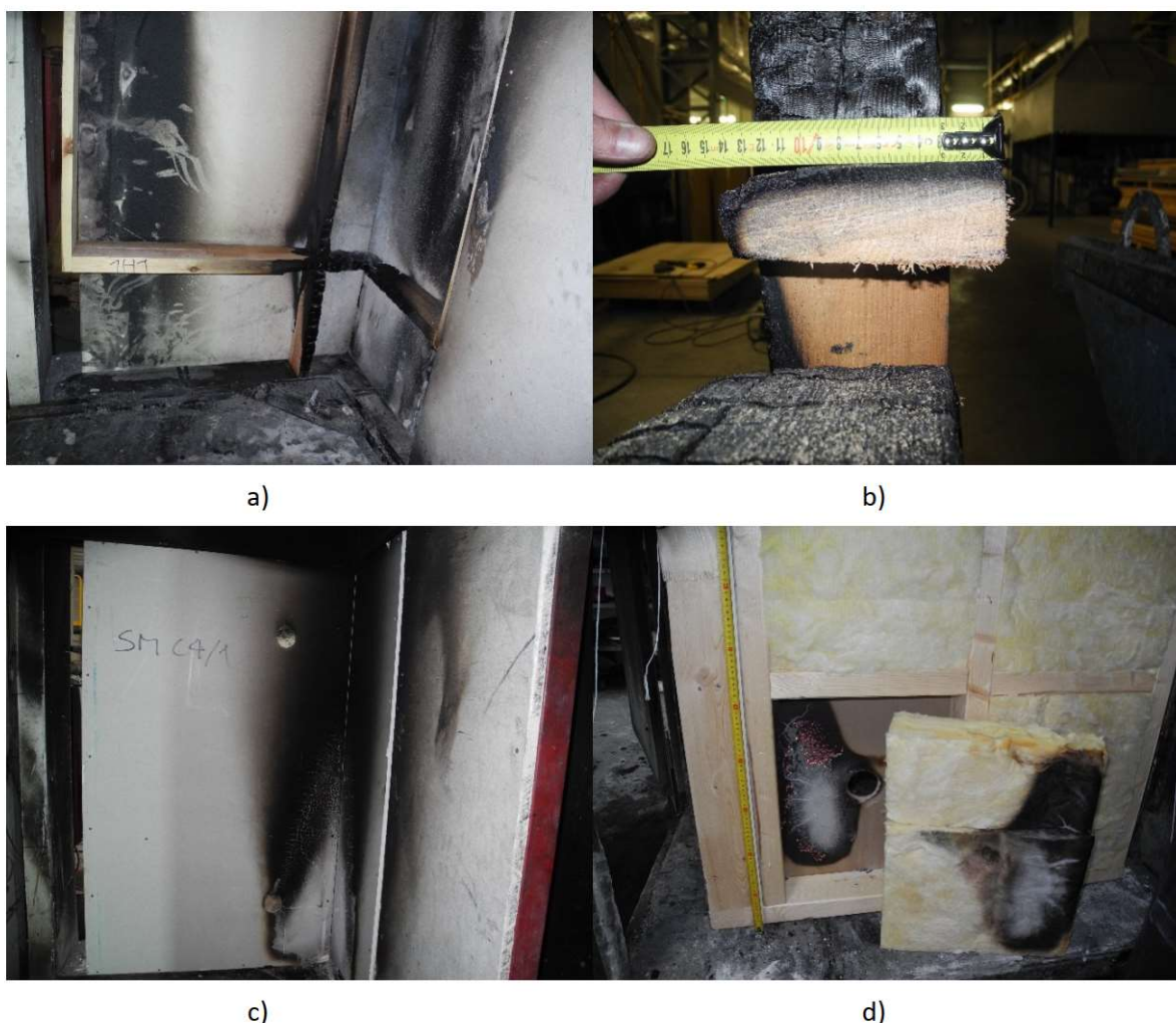
Fot. 6.7. Widok elementów drewnianych po badaniu SBI [N17]: a) i b) – elementy drewniane nieosłonięte; c i d – elementy drewniane osłonięte pojedynczą płytą gipsowo-kartonową typu A i szklaną wełną mineralną. (fot. P. Sulik)
