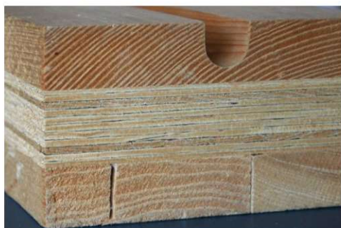
Fot. 2.10 Drewno klejone krzyżowo ze środkową warstwą z LVL, w górnej części nafrezowany kanał na przeprowadzenie instalacji (fot. E. I. Kotwica)
