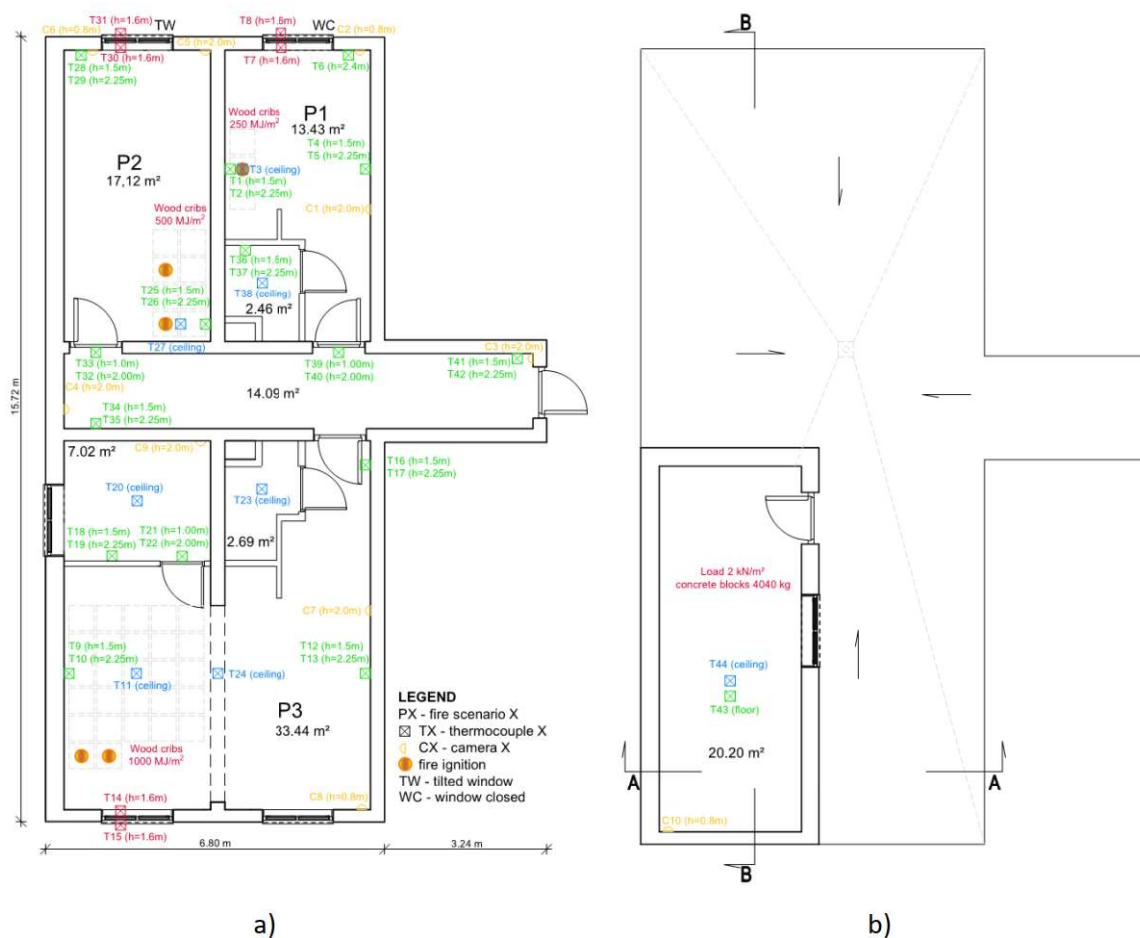
Fot. 6.16. Rozkład pomieszczeń w budynku o konstrukcji drewnianej wykorzystanego w eksperymencie pożarowym a) rzut parteru, b) rzut I piętra (rys. P. Sulik)
