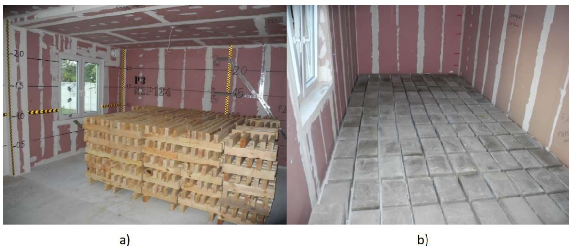
Fot. 6.18. a) przykładowe rozmieszczenie paliwa; b) obciążenie stropu (fot. P. Sulik)
