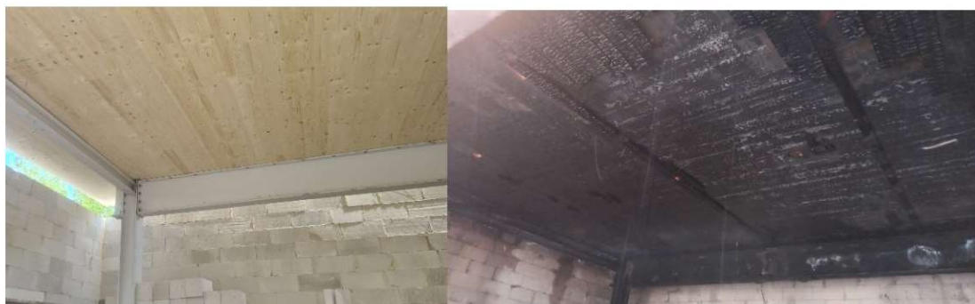
Fot. 6.11. Widok obciążonego stropu z drewna klejonego przed i po ponad 2 godzinnym w pełni rozwiniętym pożarze (fot. P. Sulik)
