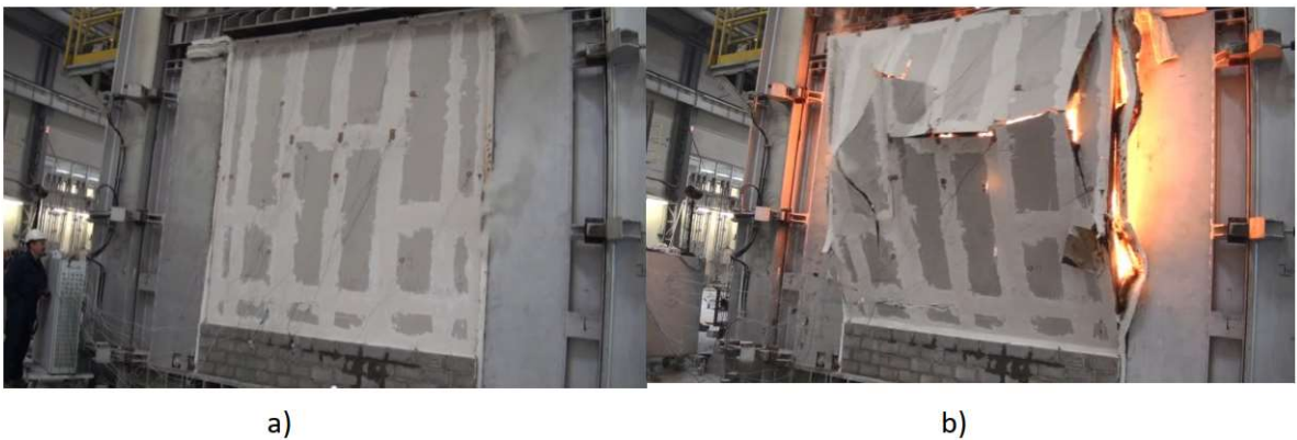
Fot. 6.13. Widok ściany nośnej o drewnianym szkieletcie z okładzinami gipsowo-kartonowymi: a) w trakcie badania, b) po przekroczeniu 60 minut, w trakcie zniszczenia (fot. Z archiwum ITB)
