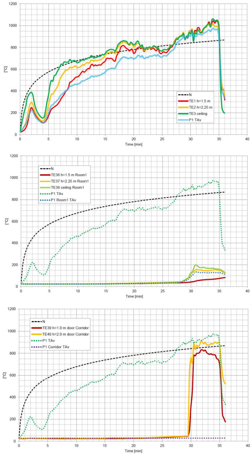
Fot. 6.25. Scenariusz pożarowy P1 – rozkład pomierzonych temperatur w czasie, w wybranych punktach. (rys. P. Sulik)
