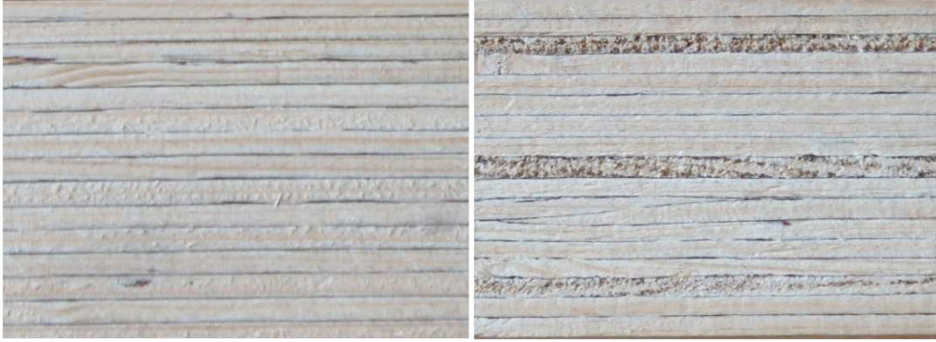
Fot. 2.11 Fornir klejony warstwowo, po lewej – LVL z równoległym układem fornirów, po prawej – LVL z krzyżowym układem fornirów (fot. E.I. Kotwica)
