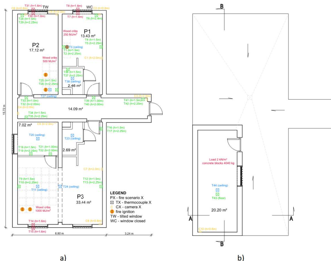
Fot. 6.7. Rozkład pomieszczeń w budynku o konstrukcji drewnianej wykorzystanego w eksperymencie pożarowym a) - rzut parteru, b) – rzut I piętra (rys. P. Sulik)
